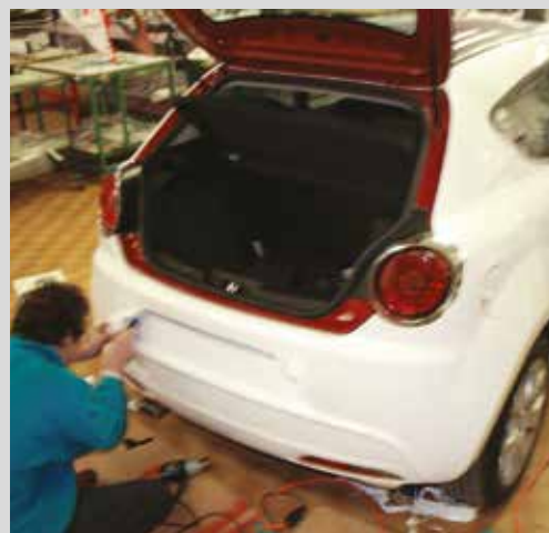
Fasi di copertura integrale del mezzo con grafica applicata (carrozzeria Alfa Mito originale rossa)
