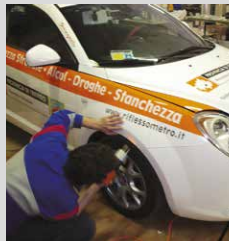
Fasi di copertura integrale del mezzo con grafica applicata (carrozzeria Alfa Mito originale rossa)
